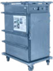
9938 Etuve électrique ventilée 8 grilles Electrique 220 V / 16A monophasé 3 kW. 1 prise. Température maxi : 250°C en 60 min. Livrée avec 8 grilles pâtisseries 60 x 40 cm. Espace entre les grilles : 7 cm. Ext. : L 65 l 105 H 132 cm. Int. : L 40,5 l 60 H 85,5 cm 150 Kg
