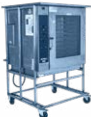
397 Four ventilé humidifié 380 V / 32A triphasé + neutre 16 kW - Prise P 17. Réservoir d'eau autonome, capacité 3 L. Réglage du thermostat de 50°C à 270°C. Fourni avec 10 grilles gn 1/1 (53 x 32,5 cm). Espace entre les grilles : 6 cm. Ext. : L 96 l 108 H 165 cm. Int. : L 69 l 41 H 53 cm. 180 Kg
