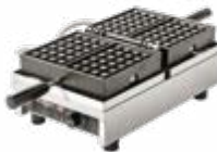
746 Gaufrier simple électrique 220 V / 16A monophasé – 1 800 W. Thermostat réglable de 50 à 300°C. Témoin de chauffe, s'éteint lorsque la température est atteinte. Dimensions : 44 × 26 × 22 cm - 2 plateaux récupérateurs de résidus de cuisson - Taille de l'empreinte : 18,2 x 11,3 cm H 2,8 cm. 20 Kg.
