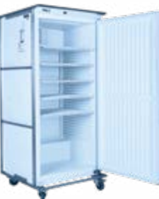
684 Réfrigérateur 500 L 220 V / 16A monophasé 150 W. Livré avec 5 grilles 68 x 52 cm. Ext. : L 80 l 80 H 180 cm. 95 Kg
