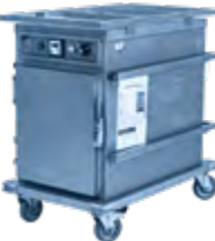
10823 Four ventilé 6 niveaux gastro 220 V Electrique 220 V / 16A monophasé - 3,5 kW. Régulation thermostatique 0 à 300°C. Ventilation intégrée. Livré avec 6 grilles gn. Ext. : L 58 l 93 H 94 cm. 103 Kg
