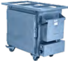
11527 Etuve électrique petit modèle 220/230 V - 16 A monophasé - 2 kW Température maxi 150°C en 30 min - Combiné adaptable pâtisseries ou gastronorme 1/1. Fourni avec 5 grilles pâtisseries 60 x 40 cm. Espace entre les grilles : 7 cm. Ext. : L 89 P 50,5 H 73 cm. Int. : L 60 P 40 H 45,5 cm
