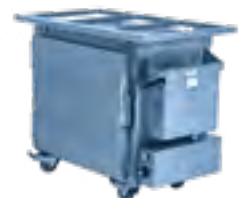
11527 Etuve électrique ventilée 8 grilles 220/230 V - 16 A monophasé - 2 kW Température maxi 150°C en 30 min - Combiné adaptable pâtisserie ou gastronomie 1/1. Fourni avec 5 grilles pâtisseries 60 x 40 cm. Espace entre les grilles : 7 cm. Ext. : L 89 ; P 50,5 ; H 73 cm. Int. : L 60 ; P 40 ; H 45,5 cm
