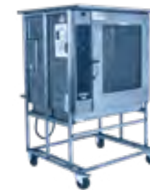
397 Four ventilé humidifiée 380 V / 32A triphasé + neutre 16 kW - Prise P 17. Réservoir d'eau autonome, capacité 3 L. Réglage du thermostat de 50 à 270°C. Fourni avec 10 grilles gn 1/1 (53 x 32,5 cm). Espace entre les grilles : 6 cm. Ext. : L 96 ; l 108 ; H 165 cm. Int. : L 69 ; l 41 ; H 53 cm. 180 Kg
