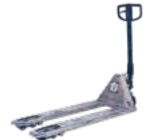
1102 Transpalette L 155 ; l 53 cm. Hauteur du bras de traction : 123 cm. Support bras de levage : 2 roues caoutchouc. Support de fourches : 4 roues nylon. Capacité de levage : 2 t. 65 Kg
