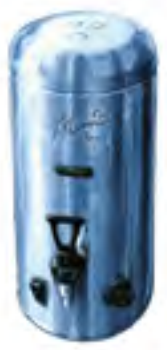
20598 Conteneur isotherme sans jauge Contenance 20 L Pour la conservation et la distribution de boissons chaudes Equippé d'un robinet anti-goutte et de poignées Dimensions : H 576 mm. Ø 307 mm. Hauteur de déversement : 120 mm. 10,3 Kg
