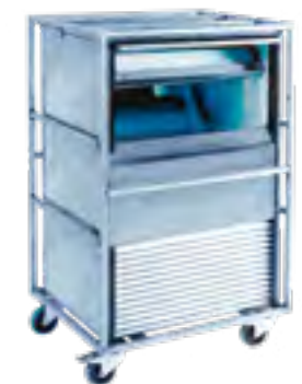
27089 Machine à glaçons Int. : L 67 x P 56 cm H 98 cm Ext. : L 72 x P 66 cm H 116 cm Porte glissant vers l'intérieur - 775W 30 mn de mise en marche et refroidissement Cycle de 15 mn = 55 glaçons Production de 75 Kg /24h Stockage 37 Kg - Poids 60 Kg En complément : pelle à glaçons page 319
